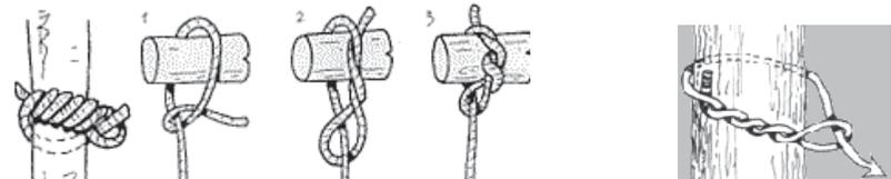
Serve per ancorare un oggetto, per iniziare una legatura (in alternativa al nodo picchetto), per legare un carico da trascinare o da issare, ad esempio una fascina di legna (in alternativa al nodo Savoia). Utile perché su una superficie non liscia non si scioglie involontariamente.
