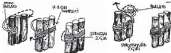
Una volta completati i giri, si fa una strozzatura in entrambi gli spazi tra i pali, e infine si chiude la legatura, per es. con un altro picchetto.
