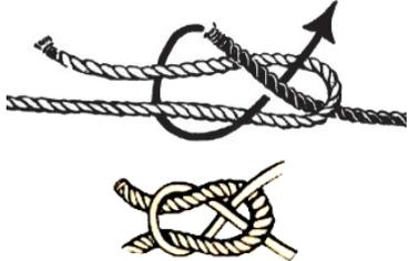
Si usa per unire due corde, anche di spessore diverso; resiste a strappi o a variazioni di tensione ed è adatto anche per forti pesi. Si puo' usare per fissare le bandiere, e per fabbricare una rete (o un'amaca). Si fa un'asola con la corda più grossa; il corrente della corda sottile lo si introduce nell'asola, vi si gira attorno e lo si incrocia infilandolo sotto il dormiente della corda sottile stessa.
